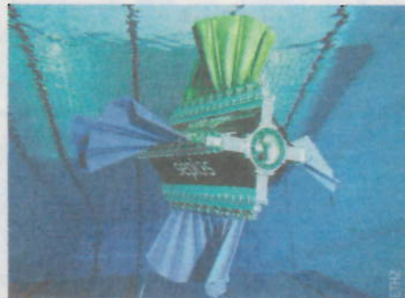
Der Unterwasserroboter Sepios imitiert die wellenartigen Flossenbewegungen gewisser Tintenfische.
